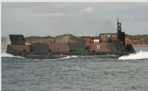
Bei den Tests der britischen Marine fuhr das PACSCAT, ein Prototyp eines Luftkissen-Katamarans, bis zu 30 Knoten schnell.
