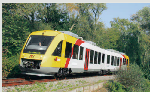
Alstom erhielt für LINT-Triebwagen das erste MTU-Powerpack, das die ab 2012 geltenden Emissionsrichtlinien der Stufe EU III B einhält.
